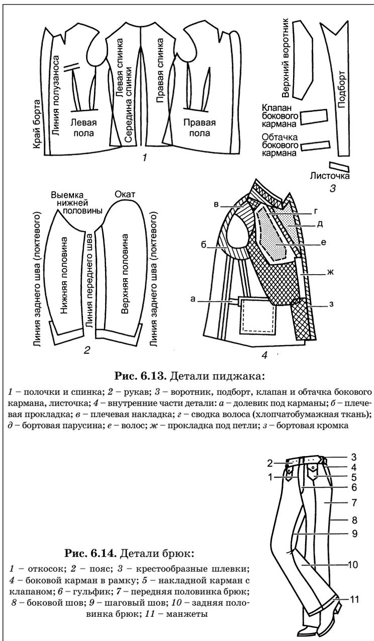
В пошивочном цехе в определенной последовательности происходит соединение выкроенных деталей одежды в соответствии с заданной моделью и конструкцией. Изделию при этом придают необходимый товарный вид, объемную форму, соответствующую модели. Форму изделию придают с помощью конструктивных линий, вытачек, сборок и влажно-тепловой обработки.
